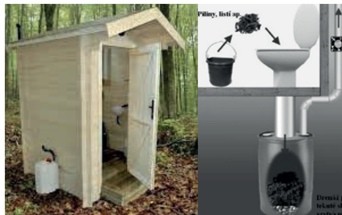
obr. 2 schéma kompostovací separační toalety
